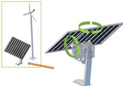
Le TRAQUÉOLE est un dispositif de poursuite du soleil permettant d'orienter jusqu'à 2 panneaux solaire de 230W. L'orientation est calculée à partir de la carte électronique qui corrige se base sur la date et l'heure afin de définir la position du panneau par rapport au soleil.
